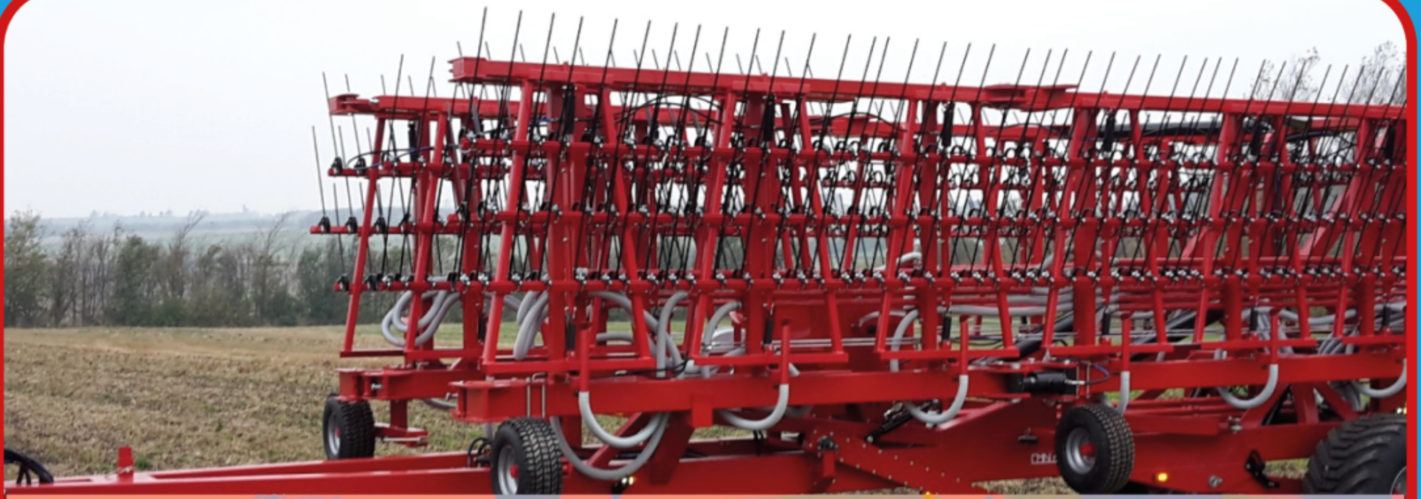
Doczepiany chwastownik CMN flex-weeder w pozycji transportowej
